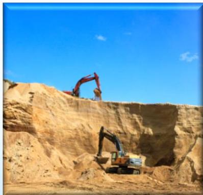
Песок по своим показателям соответствует требованиям ГОСТ 8736-2014 и может быть использован для применения в качестве заполнителей плотных, мелкозернистых и силикатных бетонов, для устройства оснований и покрытий автомобильных дорог, производства кровельных и керамических материалов, а также других видов строительных работ.
